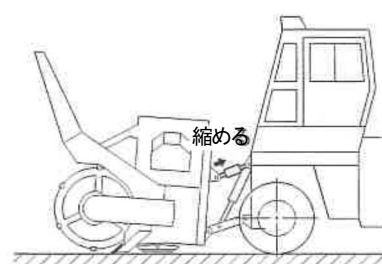
カッティングエッジによる切削
