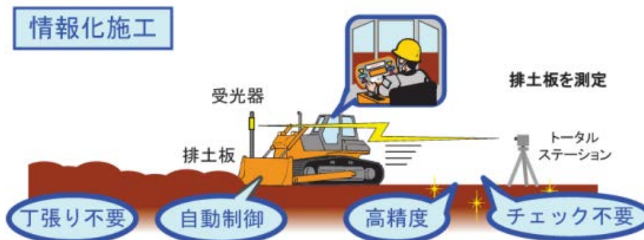
設計データを建設機械に取り込み、自動制御機能により仕上げるため、補助員が不要となる。また、経験の浅いオペレーターでも安全に熟練工並の仕上がりができる。
