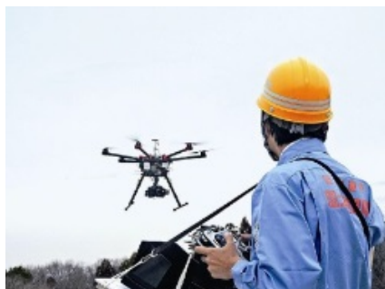
UAVやレーザースキャナーを使って測量し、短時間で広い範囲を計測
