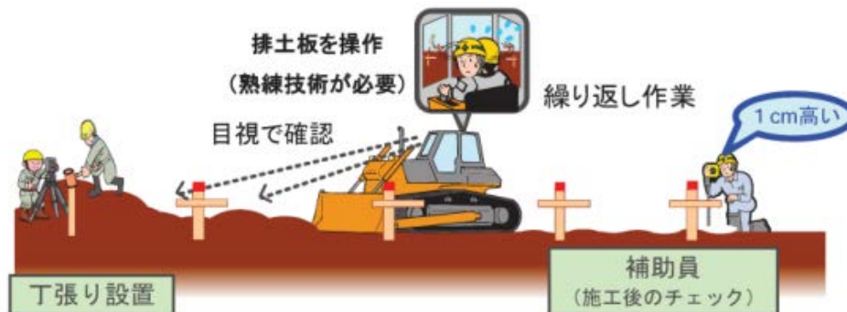
建設機械オペレーターの外に、丁張り（完成位置を示す目印板）の設置や工事中の仕上がり形を確認する補助員が必要
